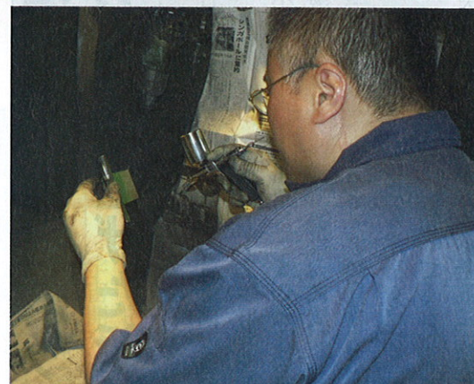
固体被膜潤滑剤の吹き付けは、1点ずつ手作業で行う(写真上は川邑社長)
